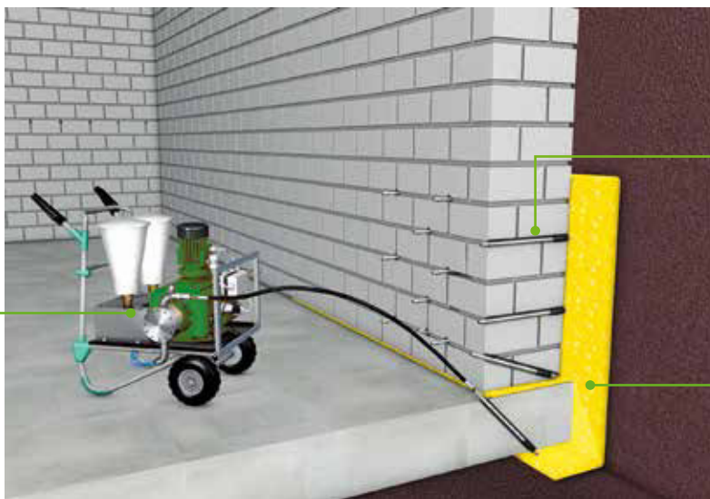
Инъекционный насос (IN 928) КЁСТЕР Инъекционный Насос для Геля
